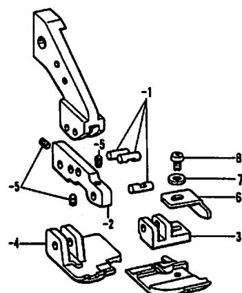
E. 押工関係/Presser foot mechanism/Stoffdrückerfuß/
