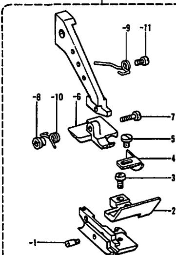
E. 押工関係 / Presser foot mechanism / Stoffdrückerfuß /
