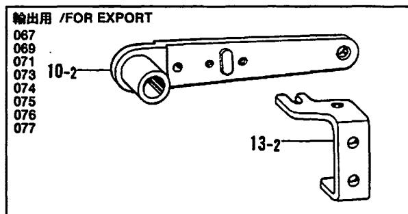
E. 押工関係/Presser foot mechanism/Stoffdrückerfuß/
