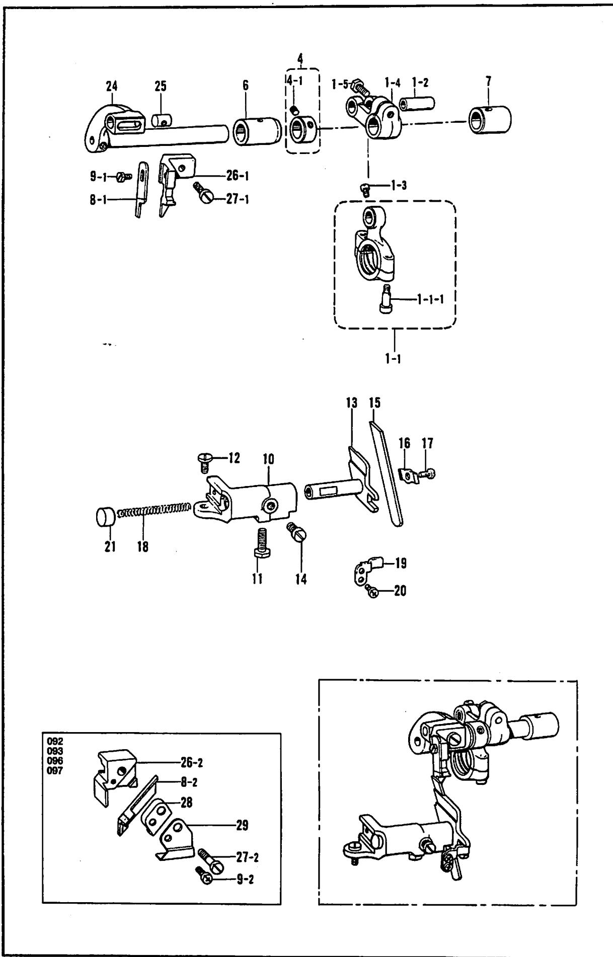
G. 上メス・下メス関係/Knife mechanism/Messer/Mécanisme du couteau/Mecanismo del cuchilla
