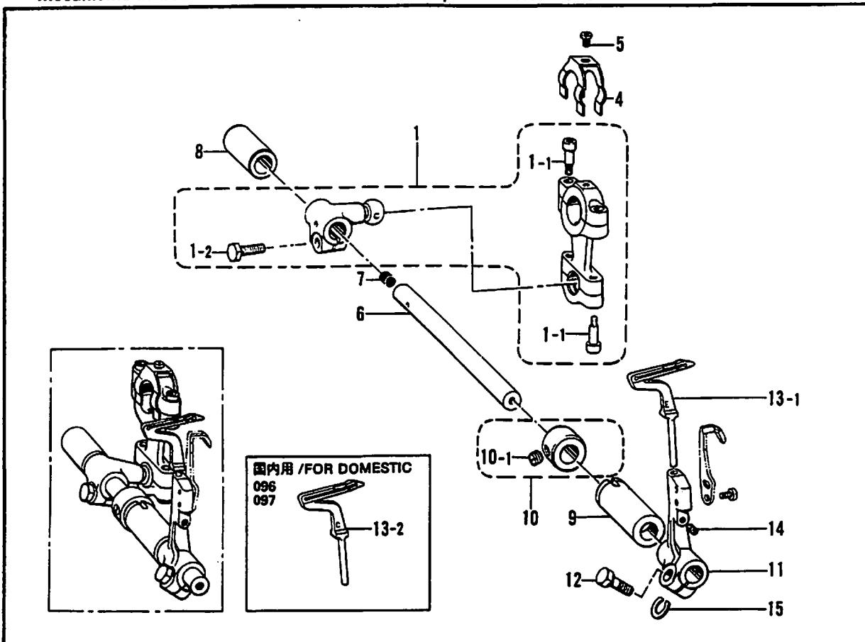
N. ラッパー関係 /Lapper mechanism/Falz-Mechanismus/
