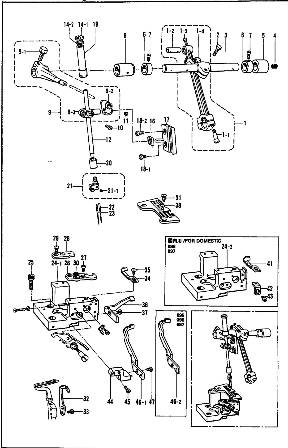
D. 針棒関係 /Needle bar mechanism/Nadelstangenvorrichtung/
